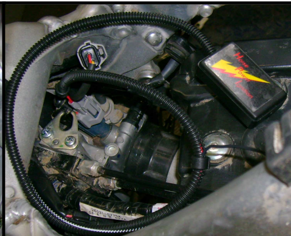
2. Plaats de EFI-box tussen de injector en de originele kabel
