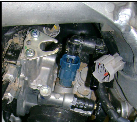
1. Maak de connector van de injector los
