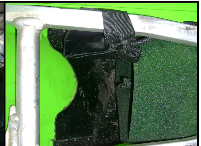
4. Plaats de EFI-box in het hoesje in de luchtfilterbak
