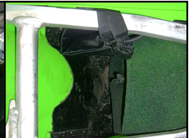
4. Placer le boîtier EFI dans le cas et dans le logement de filtre à air
