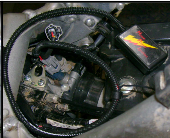
2. Placer le boîtier EFI entre l'injecteur et le câble d'origine
